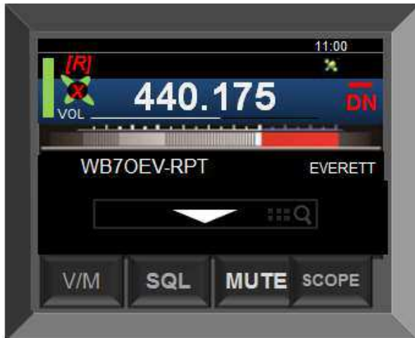
Połączenie z lokalnym węzłem na ekranie FTM/400DE
