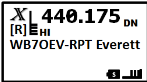
Wyświetlacz FT1(X)DE po połączeniu z węzłem lokalnym
