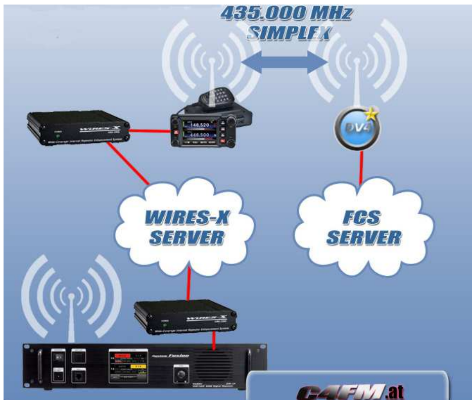
Rys. 4.8. Zasada połączenia sieci WIRES-X z reflektorem FCS za pośrednictwem DV4mini (źródło: C4FM.at). Zamiast kanału simpleksowego można korzystać oczywiście i z półdupleksowego.
