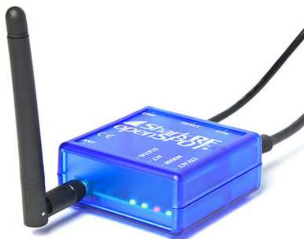
Fot. 2.9. „OpenSpot” pracuje autonomicznie bez konieczności podłączenia go do komputera ale jest wyposażony wyłącznie w złącze „Ethernet”. Pozwala za to na prowadzenie łączności skrótnych C4FM-DMR
