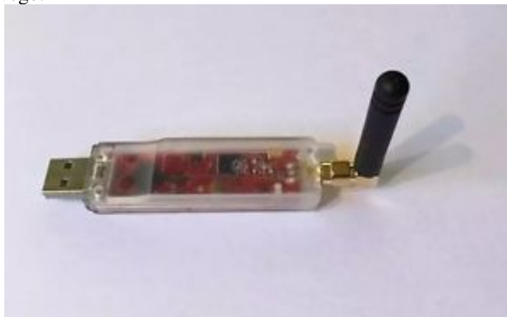
Fot. 2.5 Mikroprzemiennik DV4mini umożliwia pracę w systemach D-Star, DMR, C4FM, APCO P25, dPMR i NEXTEDEGE (NXDN). W chwili obecnej dostępne jest oprogramowanie sterujące dla Windows i „Maliny”
