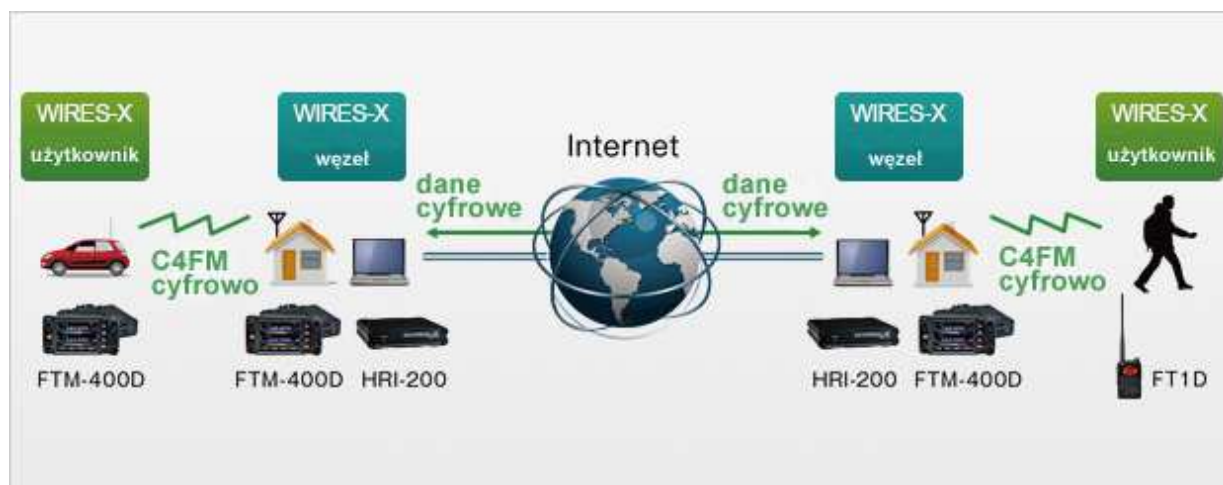
Rys. 3.1. Połączenia przemienników przez WIRES-X
